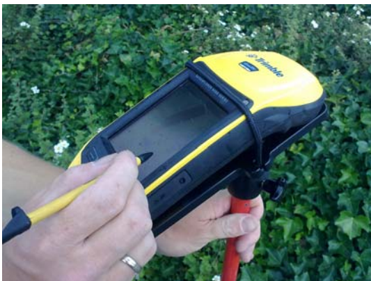
Erfassen von Geodaten sowie satellitenbasierte Lage- und Höhenvermessung mit Feldcomputer Trimble Geoexplorer GeoXH
